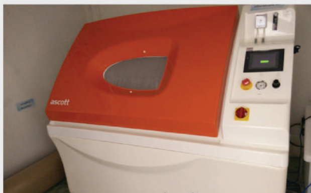
Salt Spray Machine (เครื่องพ่นละอองเกลือ) For corrosion and abrasion test // สำหรับตรวจสอบการกัดกร่อนผิวงานผ่านละอองเกลือ
