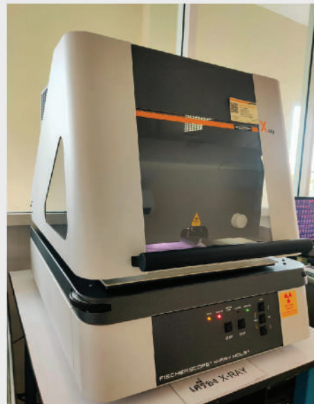
X-Ray Fluorescence Spectrometer (XRF) For thickness test measurement // สำหรับตรวจสอบความหนาของชิ้นงาน
