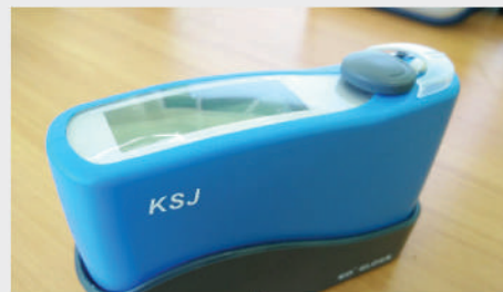
Glossmeter (เครื่องวัดความเงา) For glossy measurement // สำหรับวัดความเงาของชิ้นงาน
