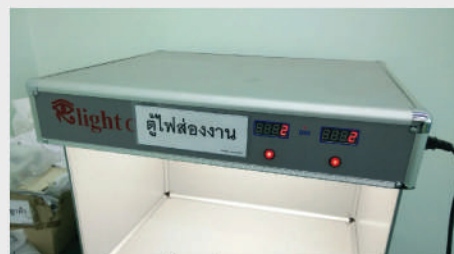
Lightbox (ตู้ไฟส่องงาน) For color comparison // เปรียบเทียบสีชิ้นงานกับงานตัวอย่าง
