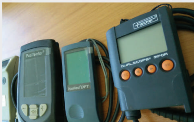
Thickness Gauge (เครื่องวัดความหนา) For thickness test measurement // ตรวจสอบความหนาหลังผ่านการชุบ
